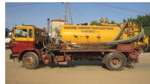
Citerne pour la collecte des déchets à partir de fosses septiques dans quartier très densément peuplé à Rufisque, Dakar, Sénégal (novembre 2011).
